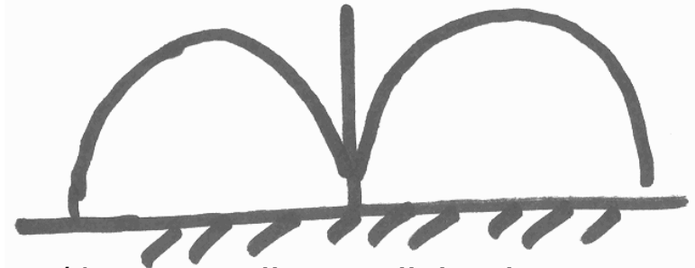
\lambda/4 monopolin säteilykuvio (puolikas dipolin säteilykuviosta)
